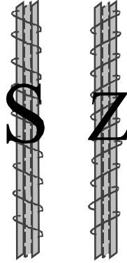
Şekil-2 : İplikte büküm yönü
