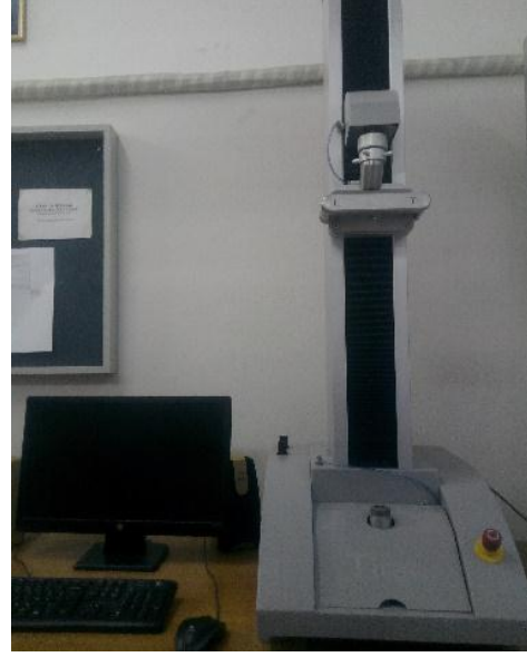
James H. Heal marka Titan model Universal mukavemet test cihazı.
