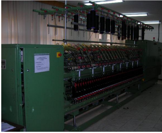
Suessen Fiomax E-2 kompakt ring iplik eğirme makinesi.
